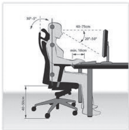
Ryc.1. Prawidłowo przygotowane stanowisko komputerowe [4]
